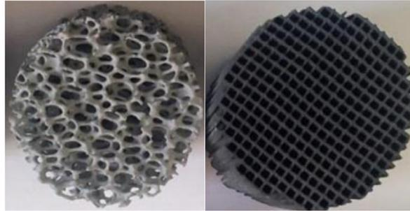
Figura 2. a) Receptor volumétrico poroso; b) Receptor volumétrico multicanal con celdas rectangulares [8].
