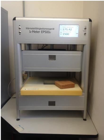
Figura 1 – Equipo de medición de conductividad térmica LAMDA METER EP500e
